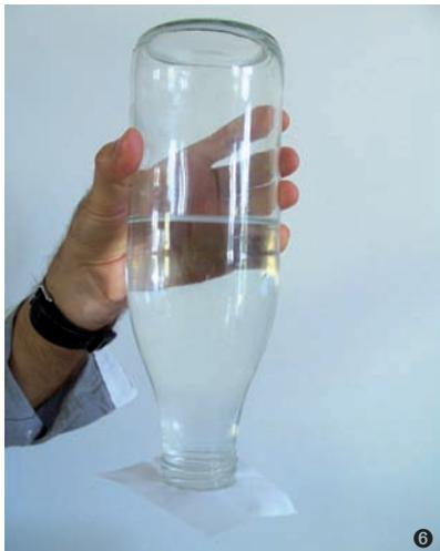
sphérique. Cette tension crée une dépression dans la bouteille, et la différence de pression entre l'air intérieur et l'air extérieur pousse l'eau à rester confinée.
